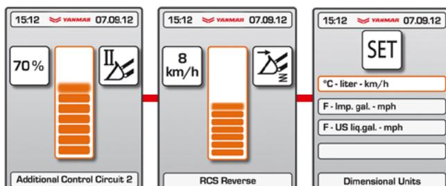
Ajustement proportionnel électrique de la performance hydraulique des 3<sup>e</sup> et 4<sup>e</sup> circuits.
