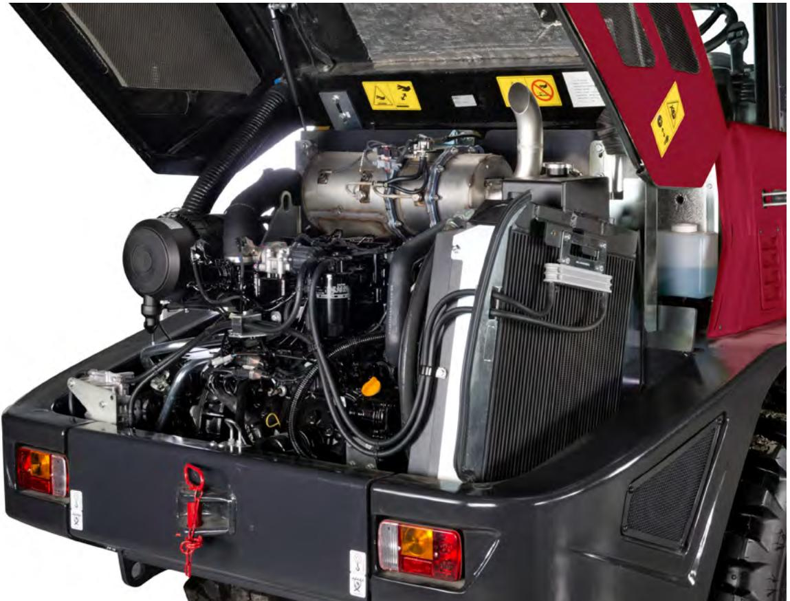
La grande ouverture offerte par le capot moteur permet d'accéder facilement à l'ensemble des principaux points de service, pour une maintenance facile et rapide. Ceci contribue à réduire le coût total de possession de la machine. Les tâches quotidiennes peuvent être réalisées depuis le sol pour gagner du temps.
