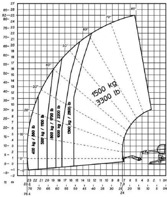
Machine sur stabilisateurs abaissés avec nacelle 365 kg
