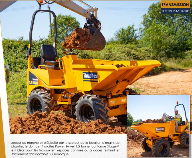
Équipé d'un moteur Yanmar d'une puissance de 15,9 kW et fournissant 66,4 N.m de couple pour une traction optimale, ce dumper est très facile à utiliser grâce à sa transmission hydrostatique.
