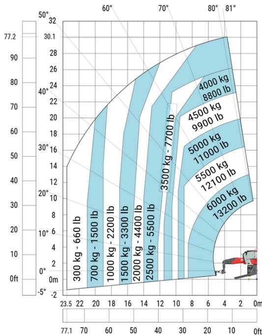
Machine sur stabilisateurs abaissés avec nacelle 365 kg (Métric)
