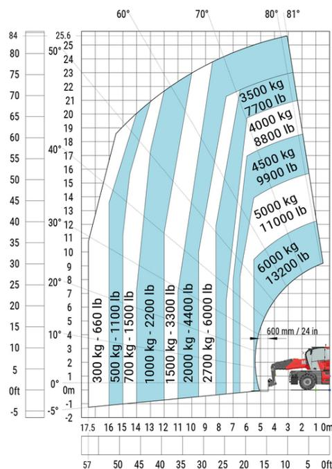
Machine sur stabilisateurs avec potence 600 kg (Métric)
