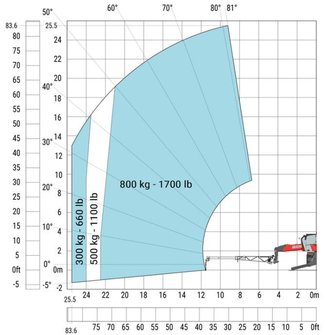
Machine sur stabilisateurs abaissés avec crochet 6000 kg
