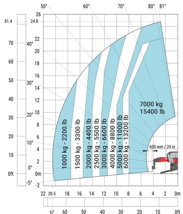
Machine sur stabilisateurs abaissés avec potence 1500 kg Machine sur stabilisateurs abaissés avec potence 2000 kg
