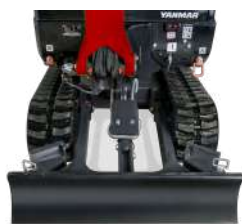
Châssis rétracté : 980 mm
