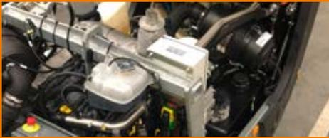
Moteur diesel Deutz respectueux de l'environnement avec une catégorie d'émissions Stage V. BluePower (en option) pour une débit maximale – permet de réduire le régime moteur pour économiser le carburant.
